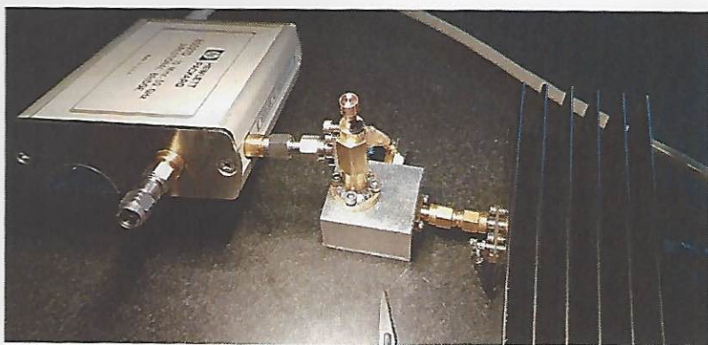
Bild 2: 50 GHz Messbrücke mit Ansteuerung 23.5 GHz/200 mW Verstärker und DL2AM 23.5/47 GHz Verdoppler. Der HF-Eingang der Brücke ist über einen selbstgebaute, abstimmbaren Rundhohl-Leiter/K-Buchse Übergang angeschlossen.
