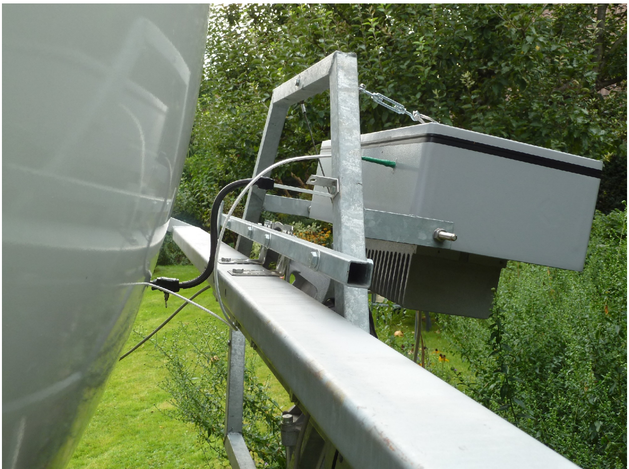
Rückseite des Spiegels mit HL-Flex-Übergang und HF-Sniffer (SMA-Buchse) – In der rückwärtigen Box befindet sich der Treiber, die TWT und die Netzteile
