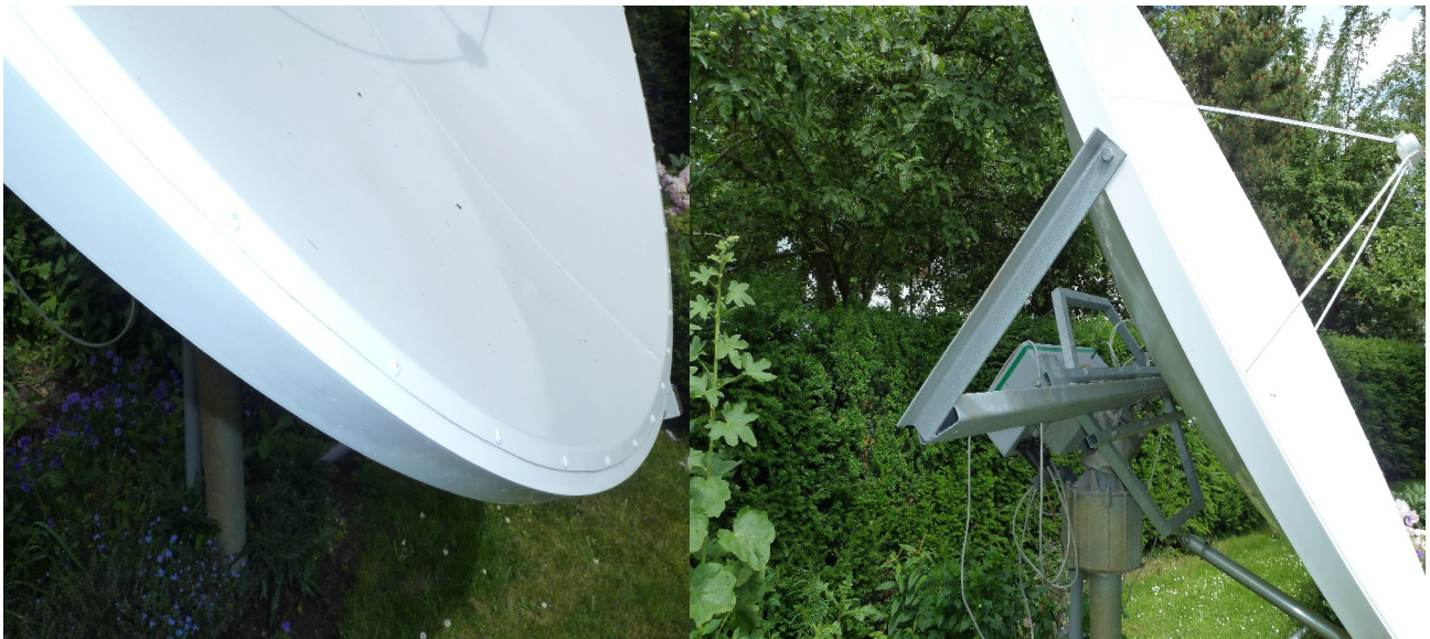
Der Vollspiegel ist in einen stabilen Ring aus 60x60mm Alu-Rohrprofil eingelegt, das nur an 2 Punkten gehalten wird
