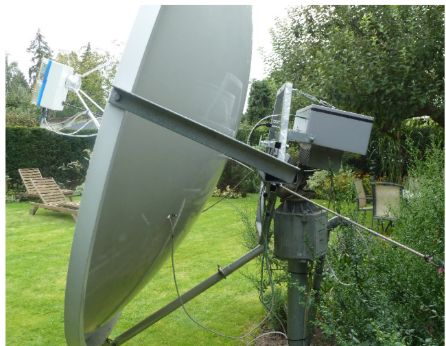
Feed-Box mit HL-Schalter, VV, Filter, Transverter und 12GHz-Oszillator (10MHz GPS controlled)
