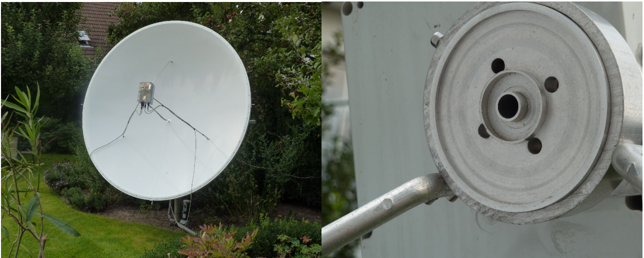
2.4m Prime-Focus Spiegel (f/D 0.38) mit Super-VE4MA-Feed (Gesamt-Wirkungsgrad > 65%)
